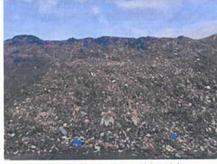
mélange biodéchets et broyats déchets végétaux en attente de mise en fermentation
